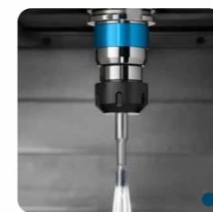
Подача СОЖ через шпиндель 20 или 30 бар
