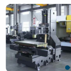
Станина цельнолитая (Mehanit)
